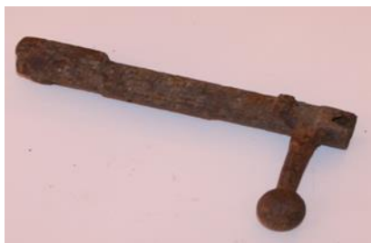
Рисунок 33 – Затвор противотанкового ружья Дегтярёва (ПТРД) образца 1941 г.
