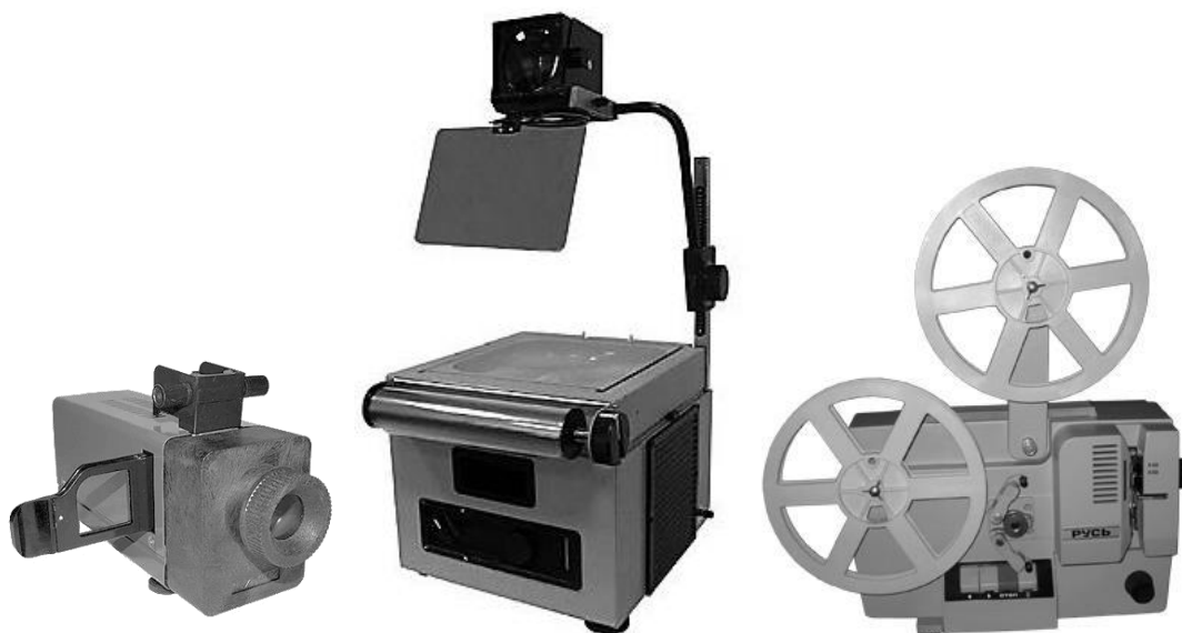
Проекционные аппараты, используемые в советской школе: диапроектор Ф75, графопроектор «Пеленг-2400» 35 , кинопроектор «Русь».
